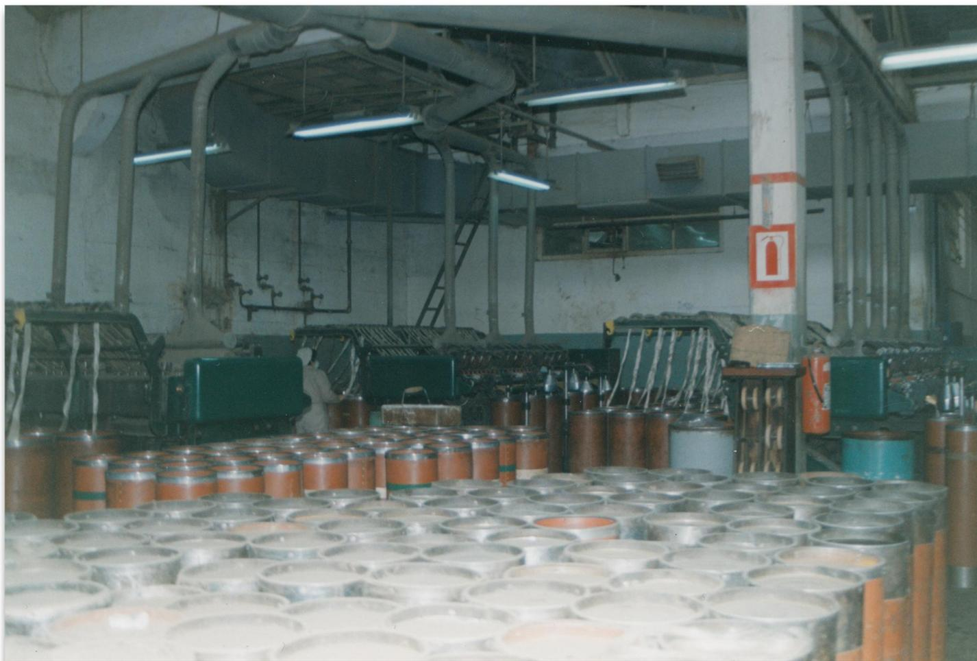
Máquina textil mechera en fábrica Linos La Unión. Esta máquina se alimenta con la cinta de lino procedente de la peinadora y da como resultado la mecha que se guarda en un carrete o bobina. La Unión, 1990. Donante: Sonia Negrón de Oppliger
