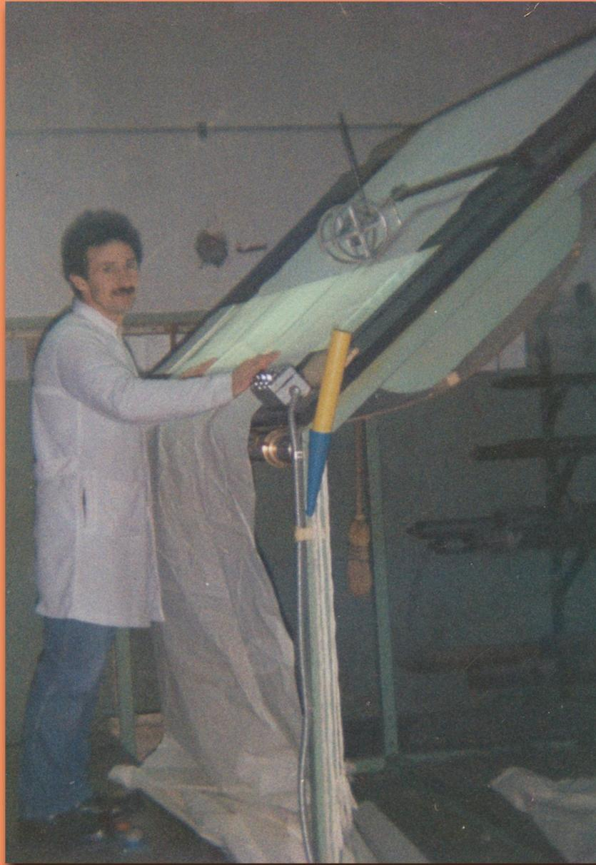
Funcionario de fábrica Linos La Unión trabaja en la máquina de control de calidad revisando telas para la detección de fallas. La Unión, 1992. Donante: Teodoro Hernández Mujica.
