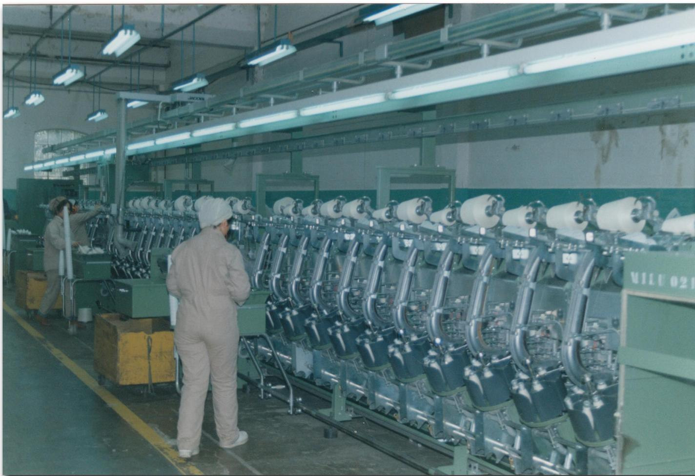
Operaria trabajando en la máquina textil hilandera en fábrica Linos La Unión. En esta máquina la fibra (mecha) es transformada en hilo. La Unión, 1990. Donante: Sonia Negrón de Oppliger
