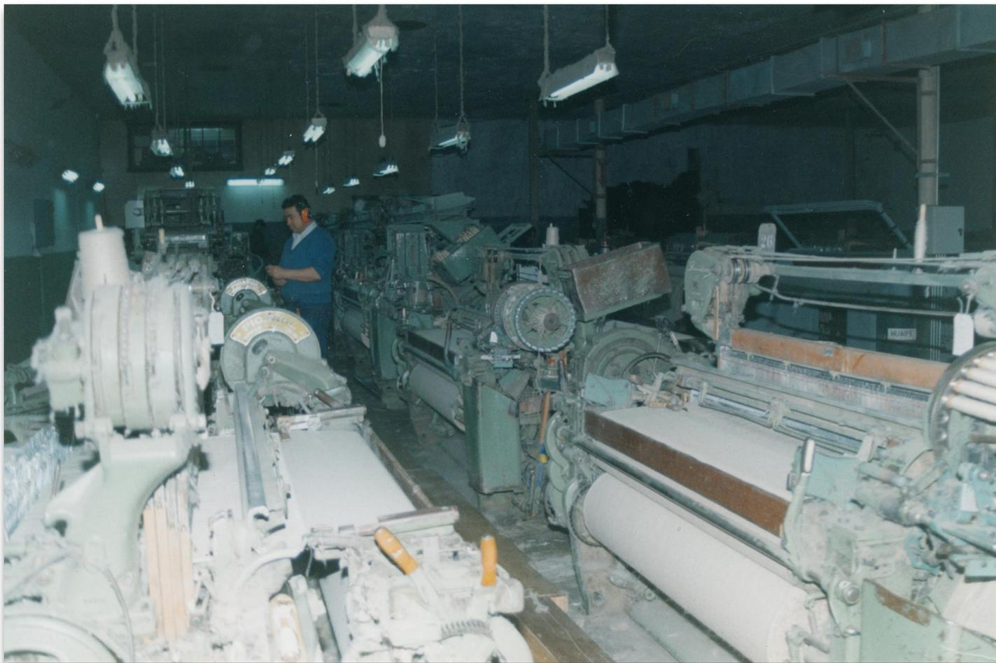
Operario de telar textil en fábrica Linos La Unión. Los telares son aquellas máquinas que transforman los hilos en telas de distintos grosores y texturas, dependiendo del tipo de hilo que se emplea. La Unión, 1990. Donante: Sonia Negrón de Oppliger.
